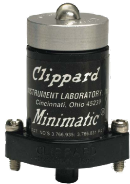
R-932 es una válvula de 4 vías, con 5 puertos, doble piloteada y con dos posiciones diseñada para módulos de entrada/salida de control de secuencia.
